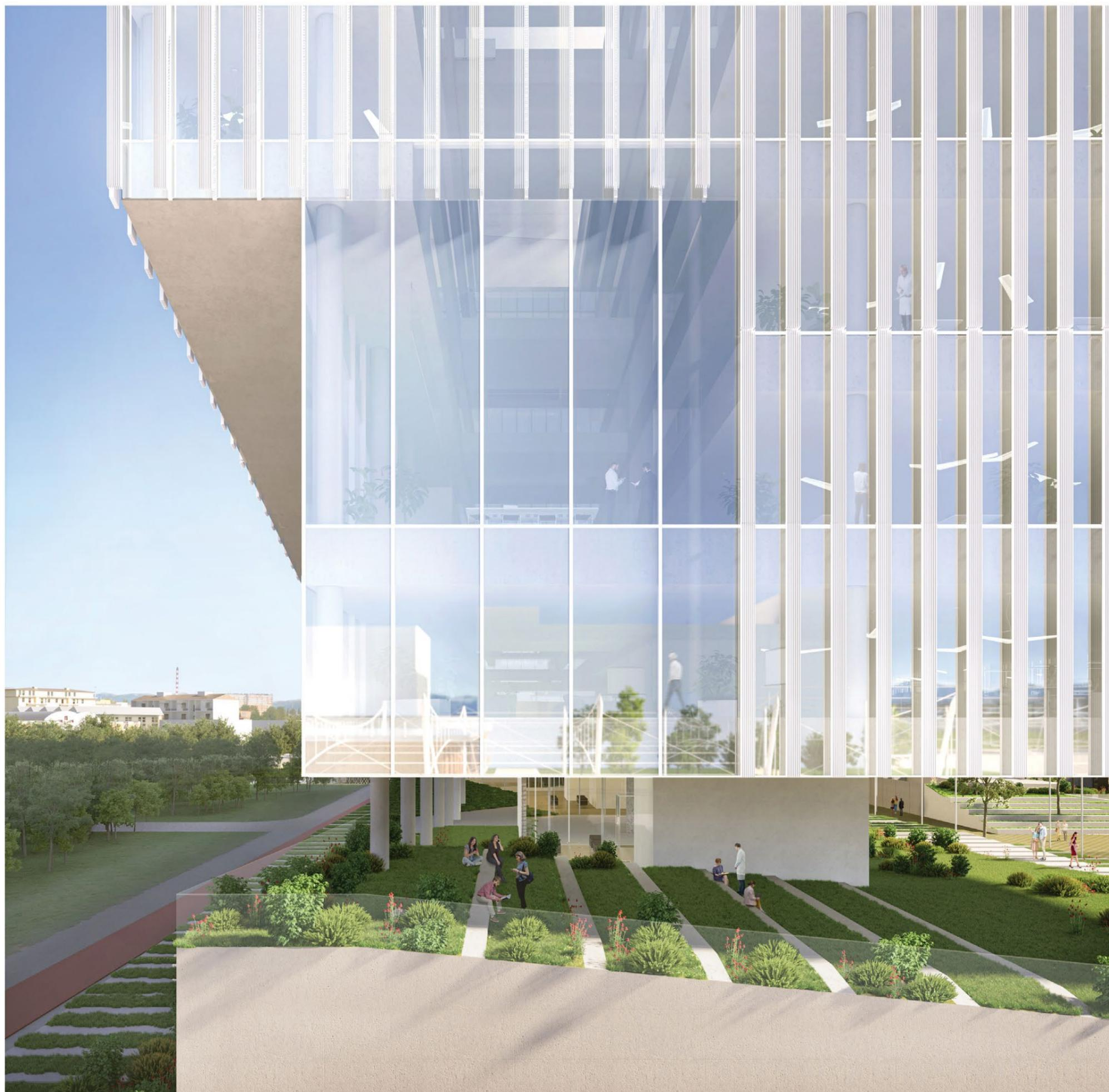
*Vista dei serramenti con vetro fotovoltaico in silicio amorfo e del sistema frangisole per il controllo dell'ambiente interno*
